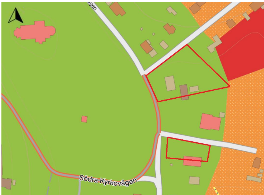
Figur 2-2. Jordarter inom undersökningsområdet. Grön=isälvsediment, orange med prickar=postglacial sand och röd=berg (Källa: sgu.se).
